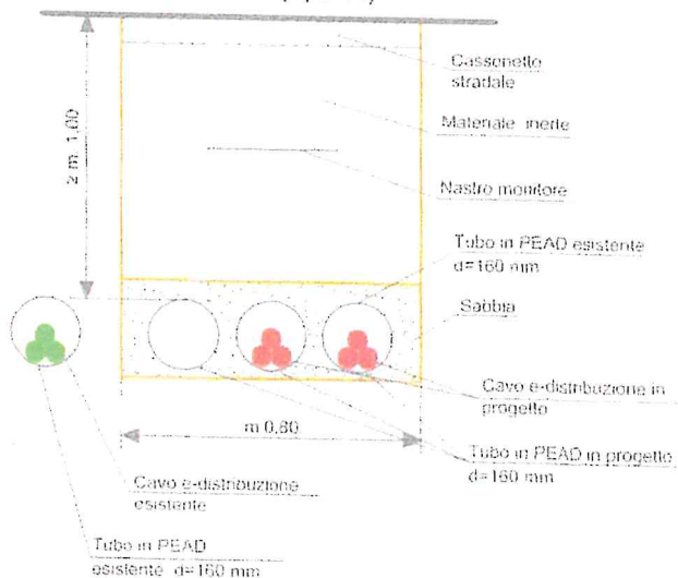
Scavo su asfalto Tratto R-S (tipo 10)
